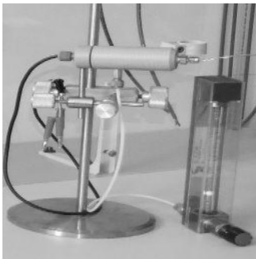
Rys. 2. Czujnik do oznaczania par benzaldehydu zbudowany z komercyjnych elektrod DropSens Co.
